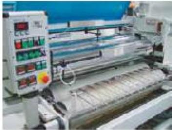
A continuación se coloca la lámina – manual- o automáticamente y se conduce la pieza a la calandra. Este sistema es adecuado especialmente para piezas de gran tamaño y rígidas
